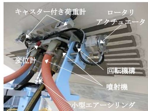
写真-5 研掃ヘッドの外観（研掃背面側）
