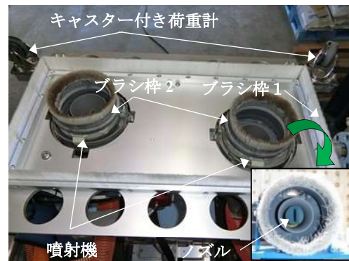
写真-4 研掃ヘッドの外観（研掃面側）
