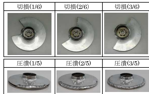
図-10 インペラの損傷状況
