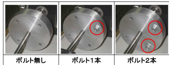
図-5 フライホイールへのボルト取り付け状況
