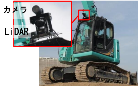
写真-4 搭載した LiDAR とカメラ
