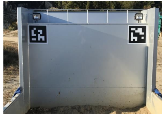
写真-5 ダンプトラックへの AR マーカ設置
