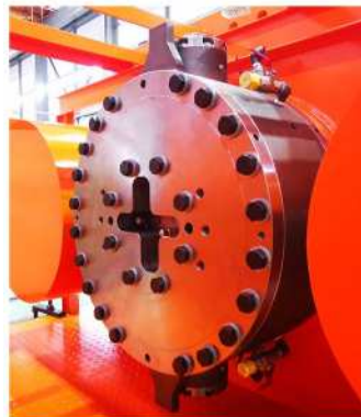
カッターフレーム内側(作業空間) DRC 交換装置本体
