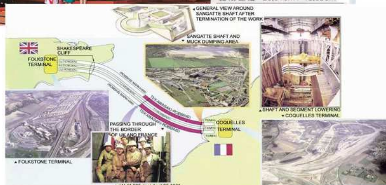
1988年 フランス ドーバー海峡海底トンネル T2 1989年 フランス ドーバー海峡海底トンネル T3 施主 EURO TUNNEL 殿 施工 T.M.L 殿 マシン外径 8.78m 掘削距離 20,010m / 18,858m
