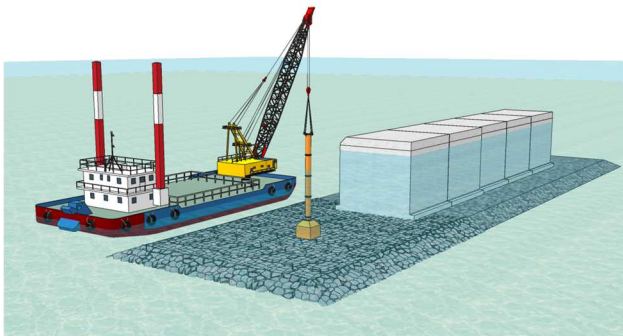
図-2 重錘を用いた基礎マウンド均し
