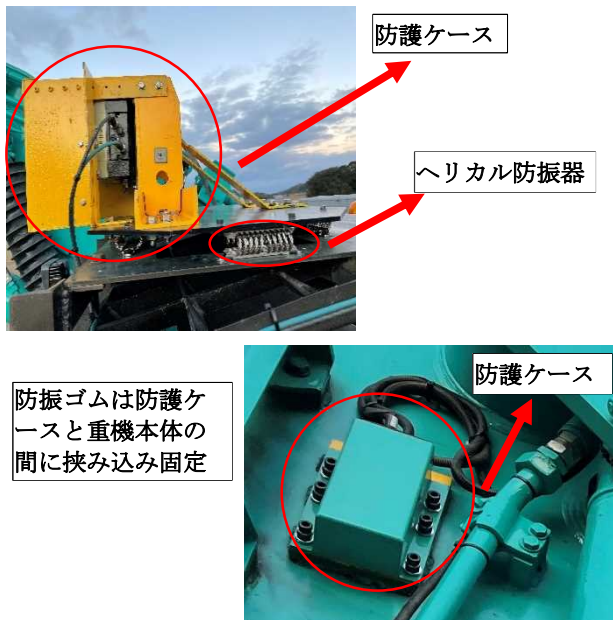
図-2 防護ケース,防振措置実施状況
