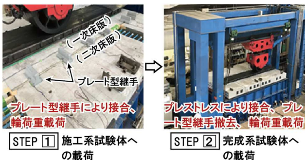
写真-10 施工ステップを追った輪荷重走行試験
