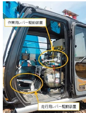
図-8 操縦席へのロボ QS 設置状況
