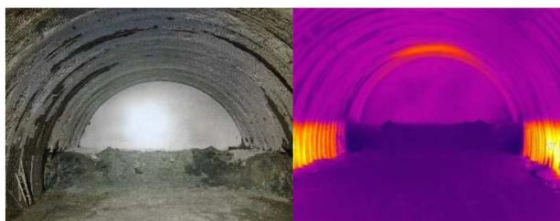
図-9 ハイブリッドカメラによるワイド画像(左)/熱赤外線画像(右)
