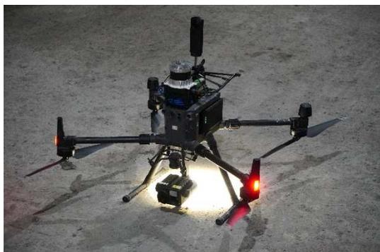
図-1 坑内自律飛行ドローン
