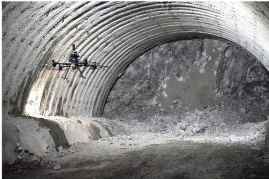
図-6 切羽認識による自律飛行停止
