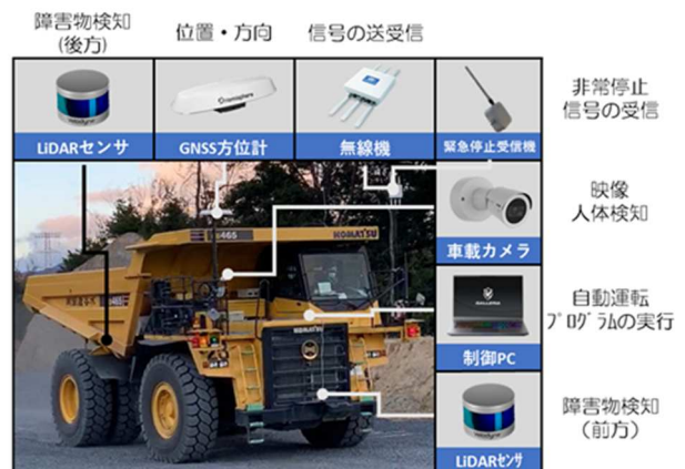
図-2 機器設置状況
