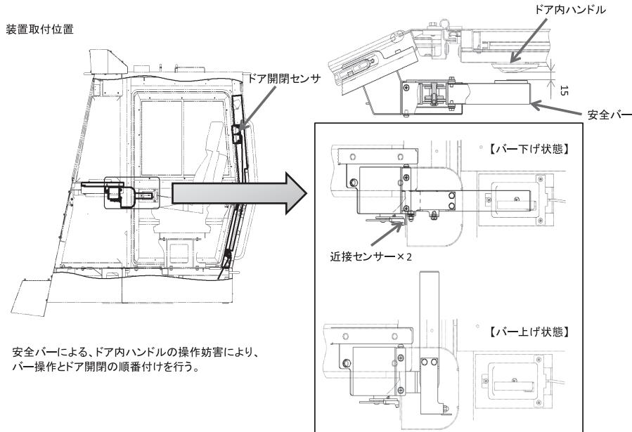
図—5 安全装置 安全バー機構概要（中・大形例）
