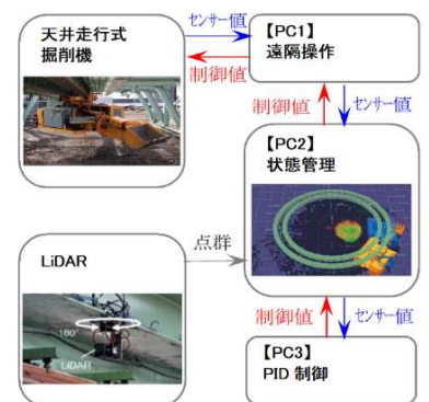
図－１ 自動掘削システムの構成
