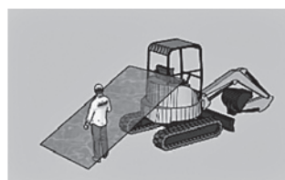
図—2 LiDAR 検出範囲のイメージ
