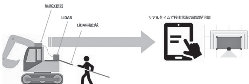
図—3 LiDAR 設定の遠隔操作の構成例
