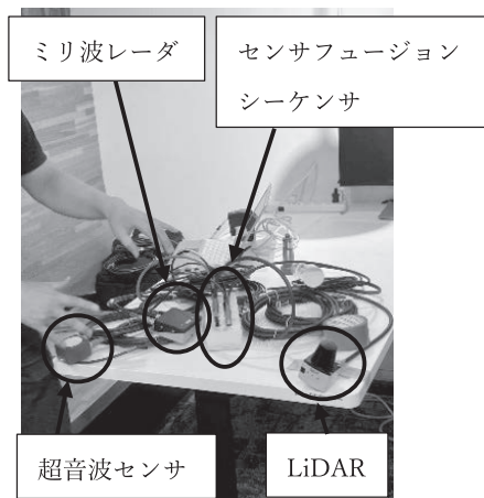
写真-8 センサフュージョンシステムのデモ風景
