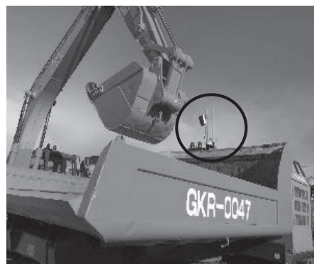
写真一三 LiDAR と RFID 受信器のダンプ実装事例
