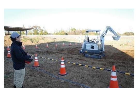
静音、低振動、低排熱の電動建機
