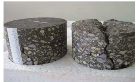
施工前のクラック(右)と施工後にクラックが閉塞している状況(左)
