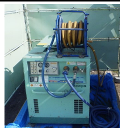
写真-4: コンプレッサー
