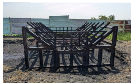
写真-5: 高速焼却装置「モヤッシー」
