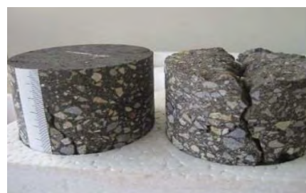
施工前のクラック(右)と施工後にクラックが閉塞している状況(左)
