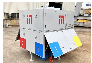
図-6 4点自動吊上げ装置
