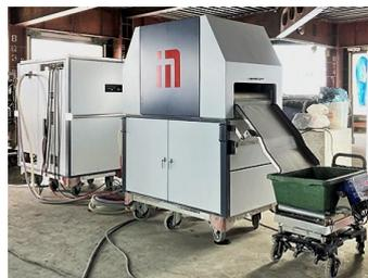
図-5 ノロ水脱水装置
