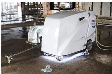
図-4 スラブ斜め切断カッター
