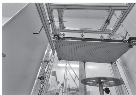
写真一十 防水試験装置（写真は一部でカテゴリ IP X1～X8, X9K に対応した各種試験装置がある）
