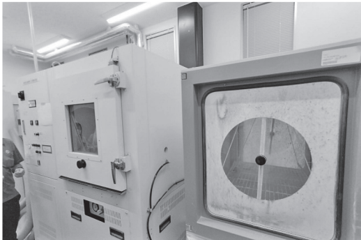
写真-11 粉塵（耐塵）試験機
