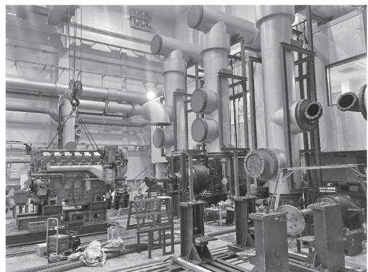
写真—5 パワーテストの準備をしているエンジン
