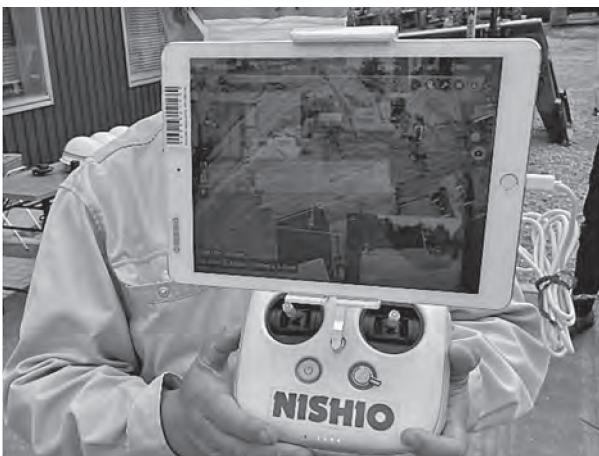
写真-10 ドローンコントローラー+表示画面
