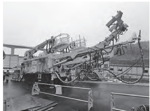
写真一5 エレクター搭載一体型吹付け機（天神トンネル作業所現場概要資料より）
