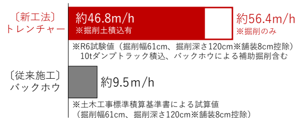
図-3 施工速度 (掘削深さ 1200 mm)
