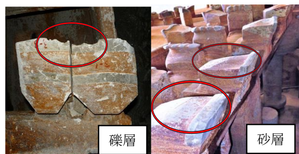
写真-1 地盤掘削後のビット例
