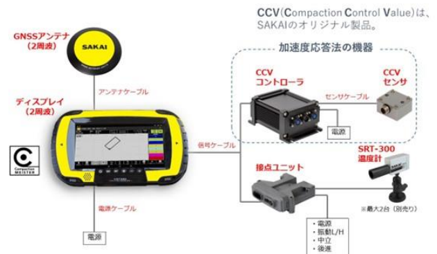
図-1 転圧管理システムの構成
