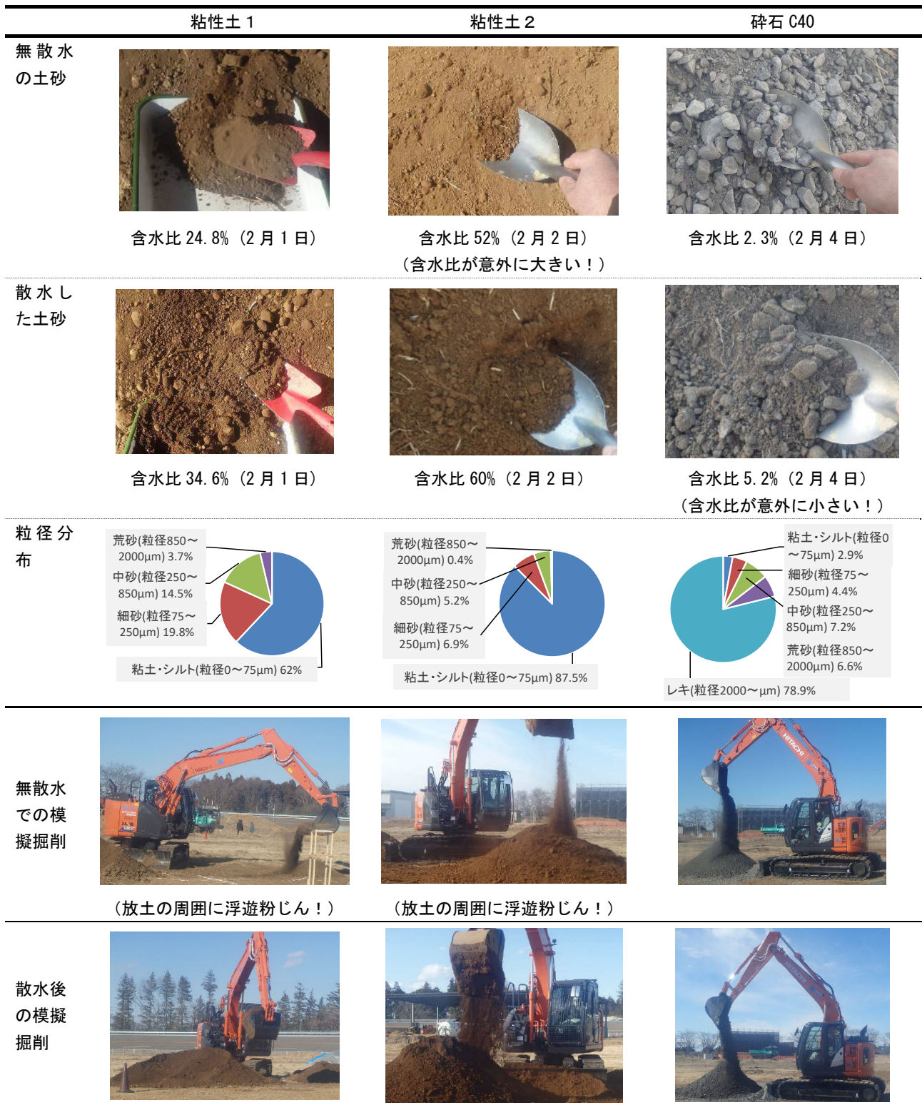
図-7 測定対象とした土砂と測定状況
