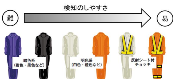
図-1 従来型 3D-LiDAR における課題
