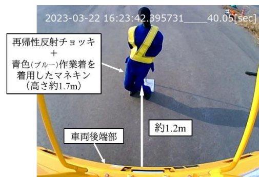
写真-1 3D-LiDARの搭載位置から見た試験の様子
