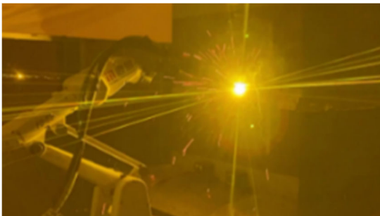
写真-13 自動溶接中の状況
