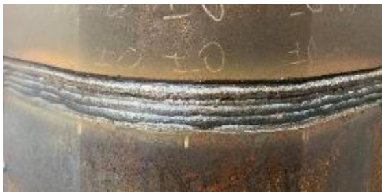
写真-10 スラグ除去後外観
