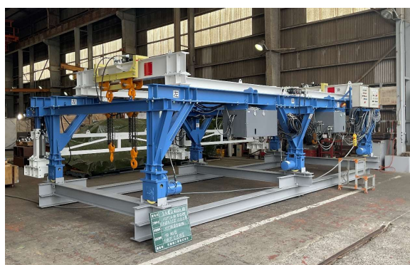
写真-5 本塗装後の床版架設機
