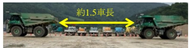
写真-5 干渉回避機能での停止状況
