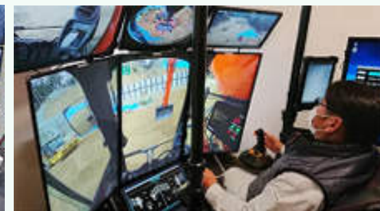
5Gを活用して3種類の建設機械を遠隔操縦 (日立建機日本株式会社HPより)
