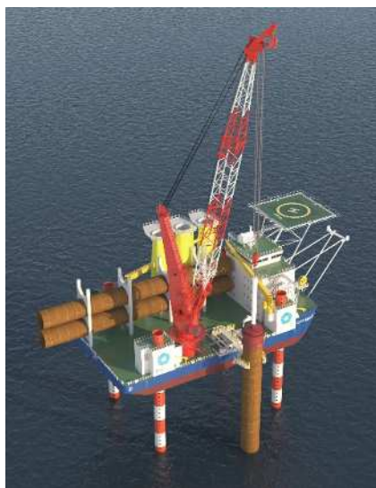
② 基礎の施工 (モノパイルetc.)
