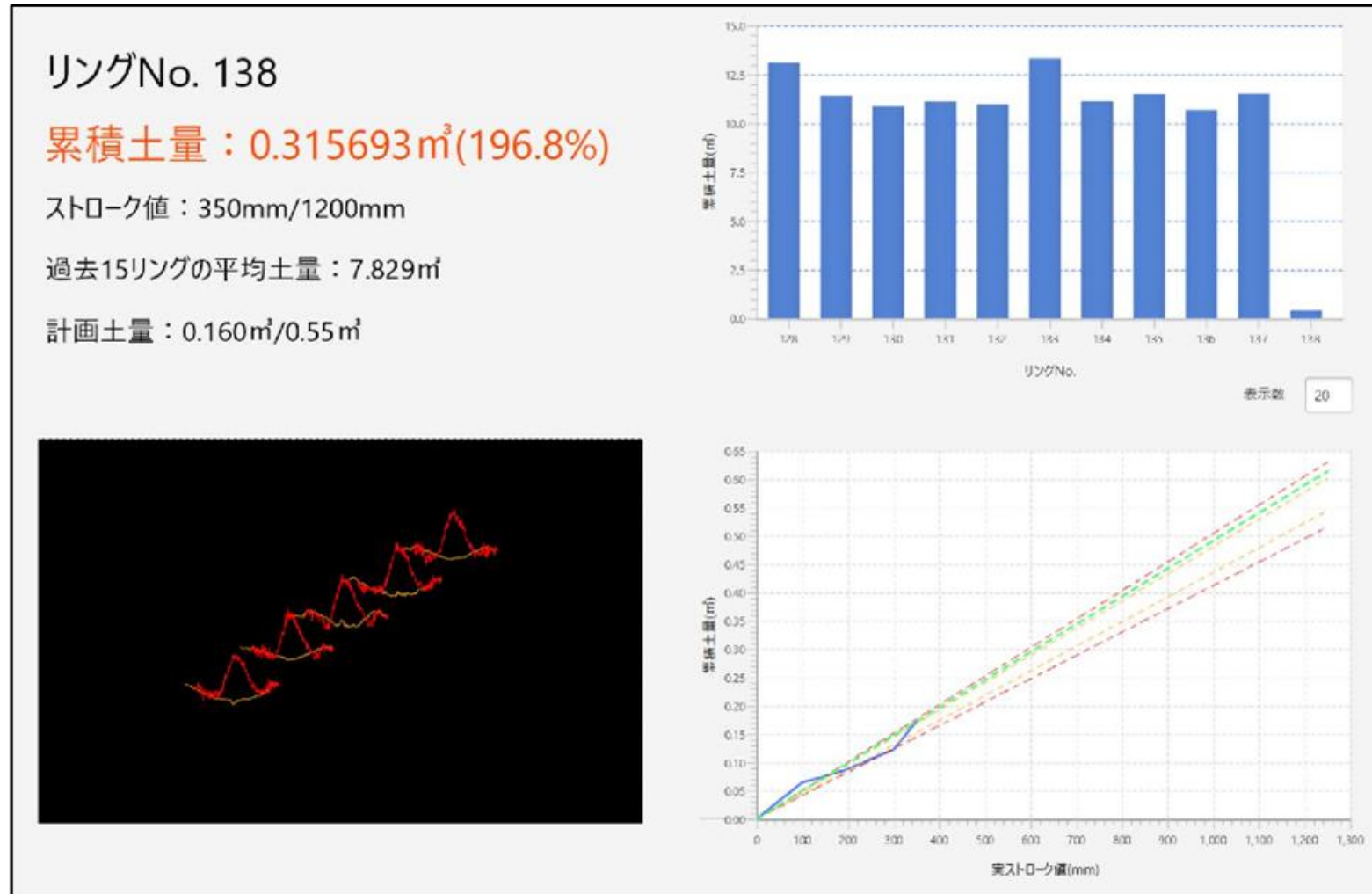
図4-6 3Dレーザースキャナを用いた掘削土量リアルタイム計測管理画面
