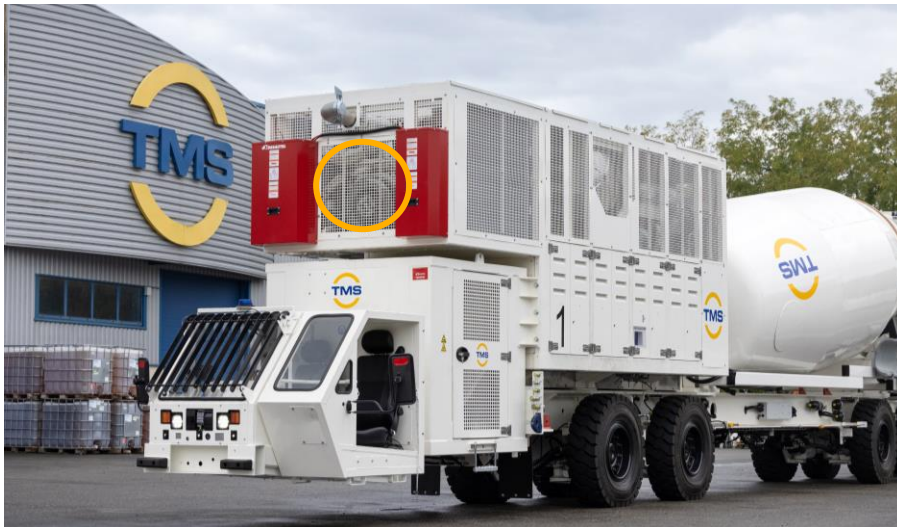
テルマセキュリティー 搭載パワーユニット
