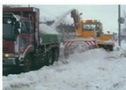
【拡幅除雪】2.6m、220kW級
