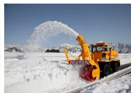
【拡幅除雪】2.6m、290kW級
