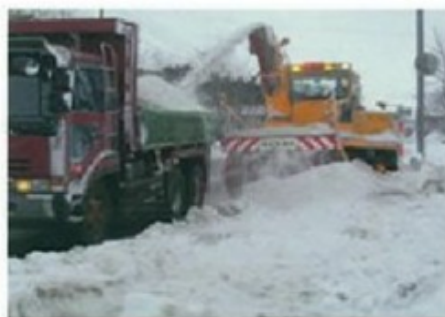
【拡幅除雪】 2.6m、220kw
