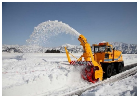
【拡幅除雪】 2.6m、290kw
