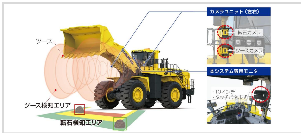
ツース脱落／転石検知支援システム
