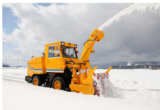
【歩道除雪】 1.3m、60kw
