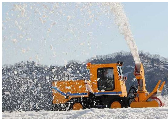
【歩道除雪】 1.0m、30kw
