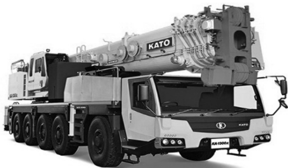
写真-2 オールテレーンクレーン
