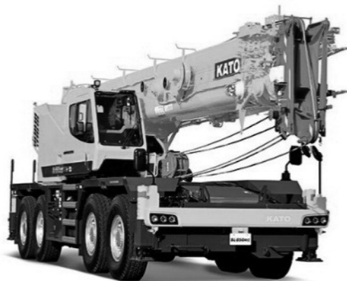
写真-1 ラフテレーンクレーン
