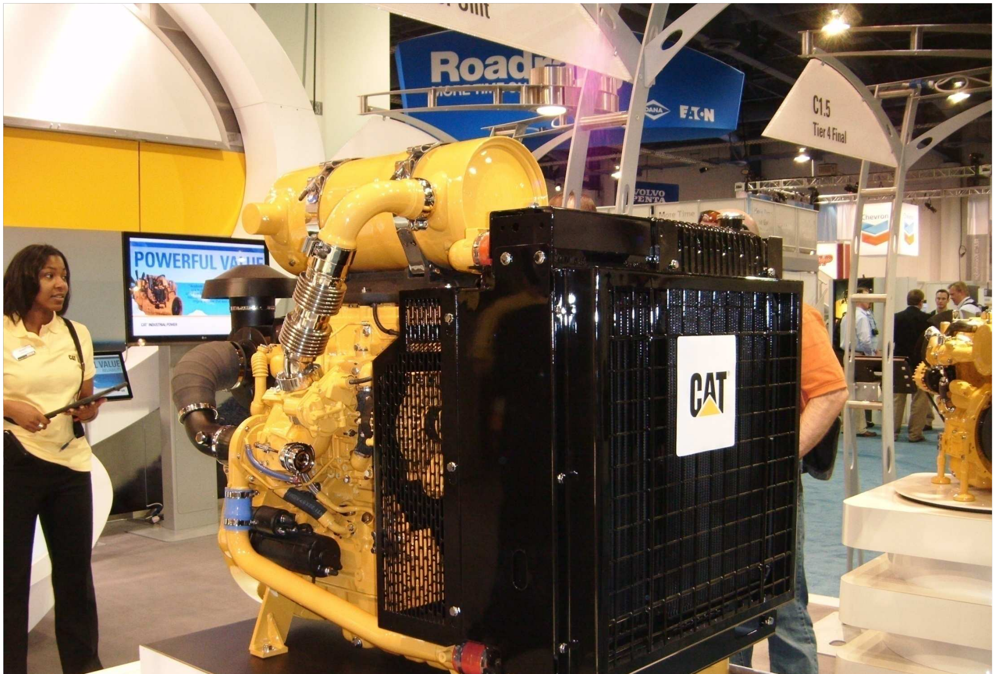
CATERPILLAR (4次排ガス規制対応エンジン)
