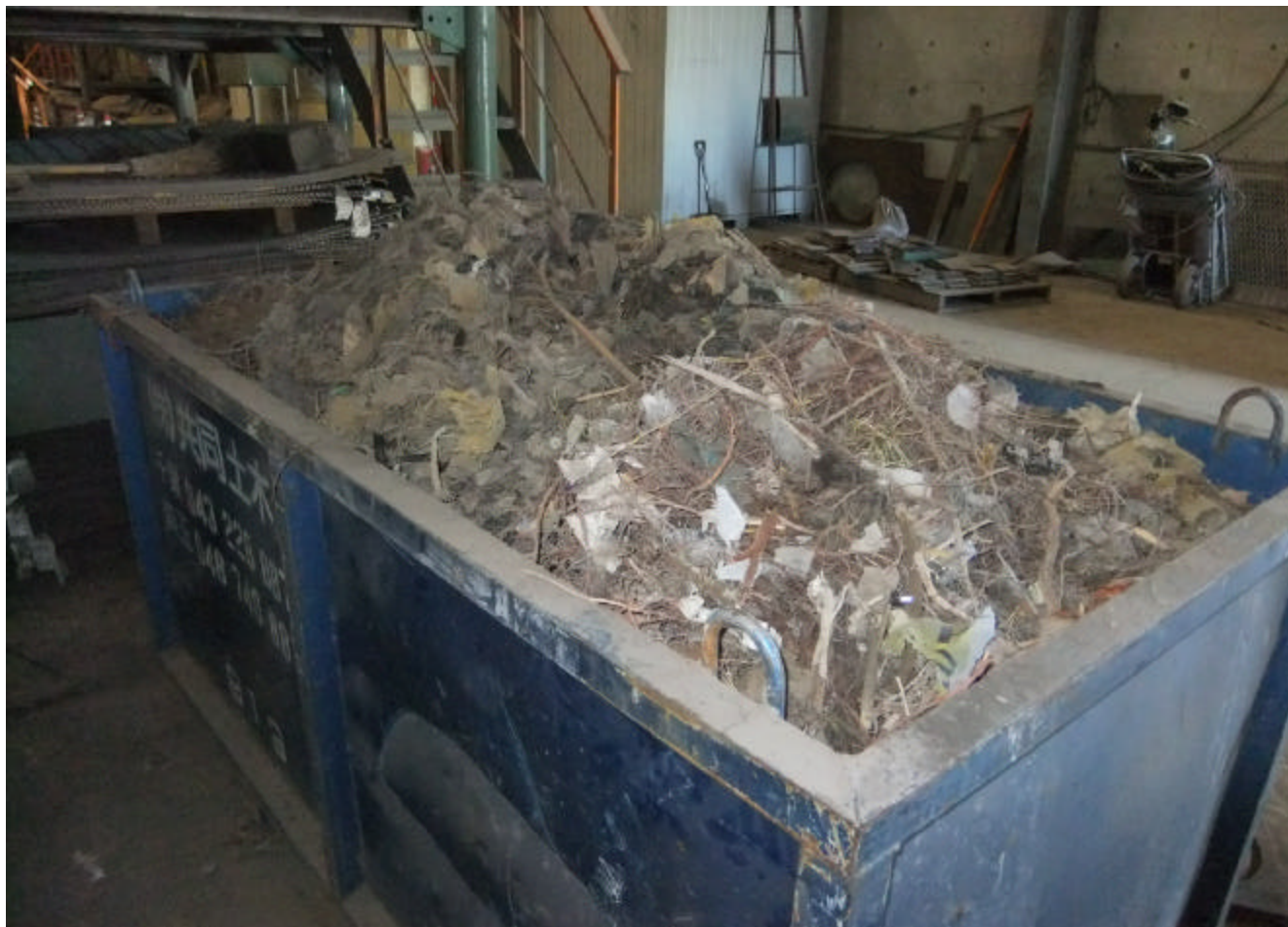
再生路盤材から回収されたゴミ(不純物)
