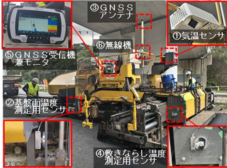
AFに設置する機器の構成
