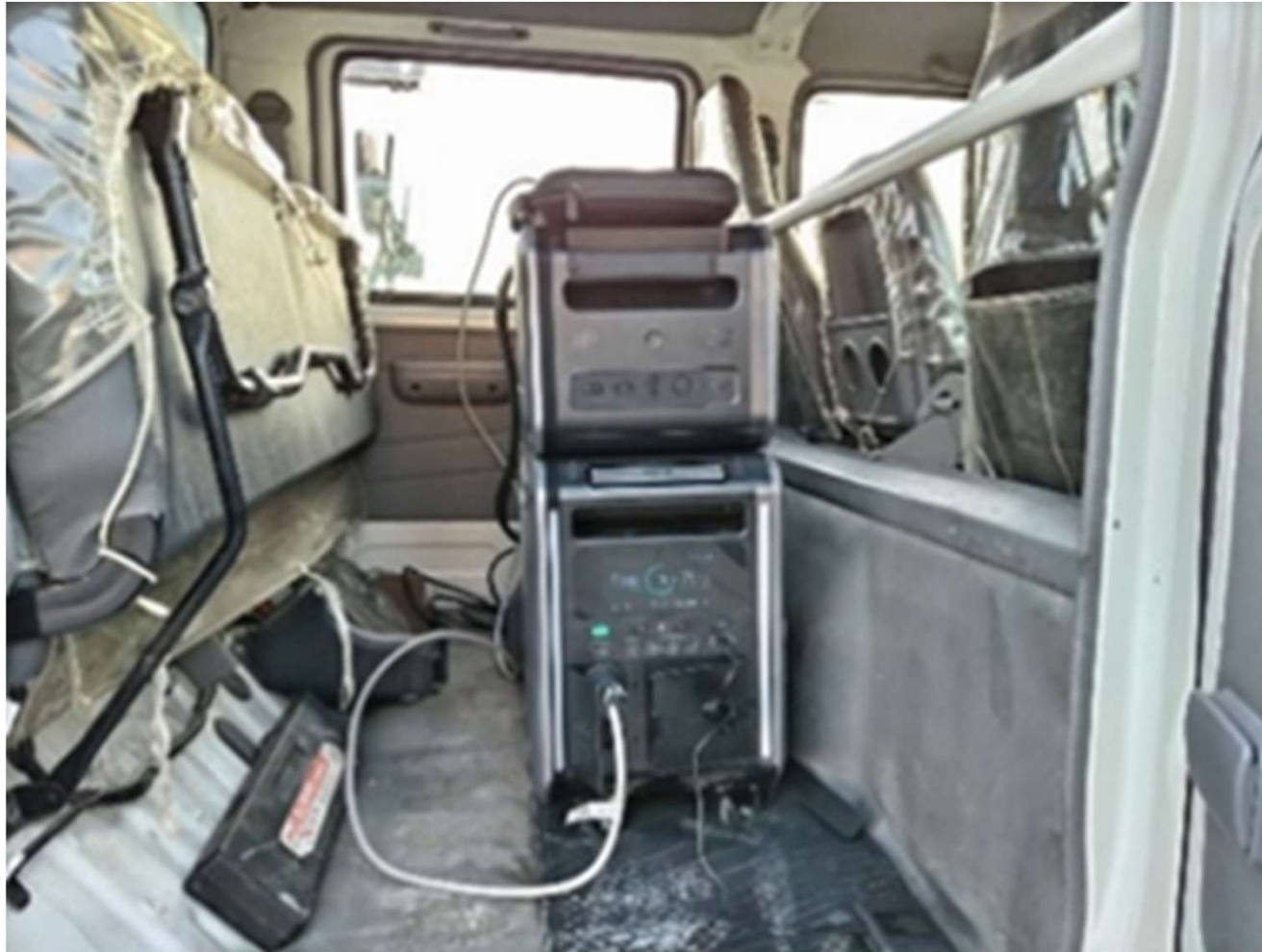
可搬式蓄電池を用いて電動ローラを充電している状況
