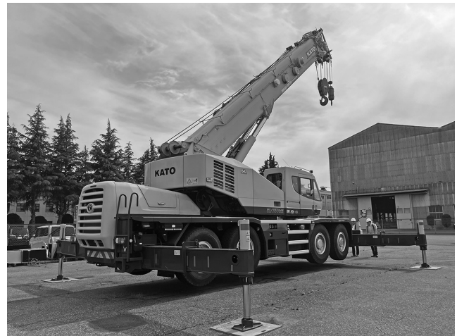
写真-2 ラフテレーンクレーン
