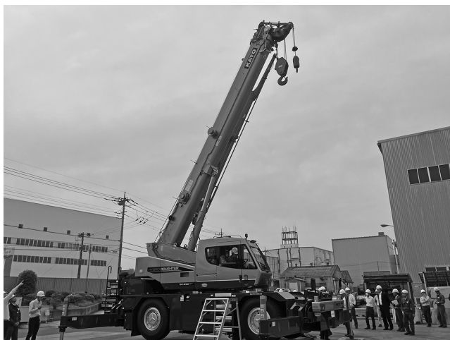
写真—4 ハイブリッドラフテレーンクレーン
