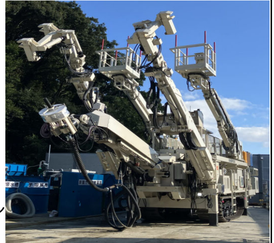
写真-1 コンクリート吹付け自動化システム
