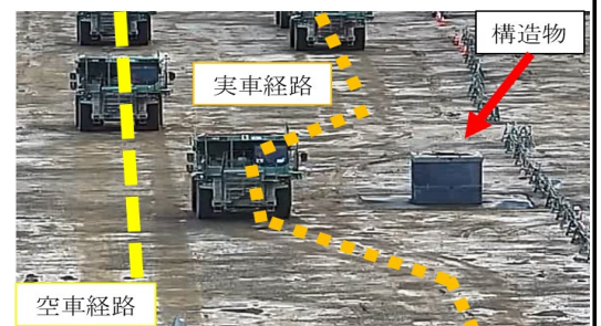
写真—5 構造物付近での自動走行
