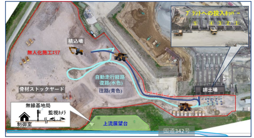
図-1 T-iROBO Rigid Dump 図-2 骨材原石運搬作業の概略
