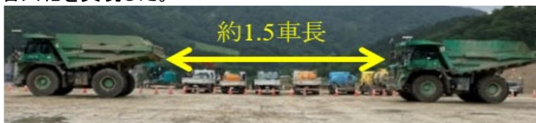
写真—3 干渉制御の停止状況
