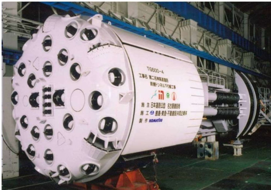
日本道路公団／第二名神高速道路 鈴鹿トンネル (φ5000mm オープン型)
