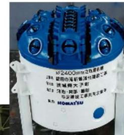
岩盤用 立坑掘削機
