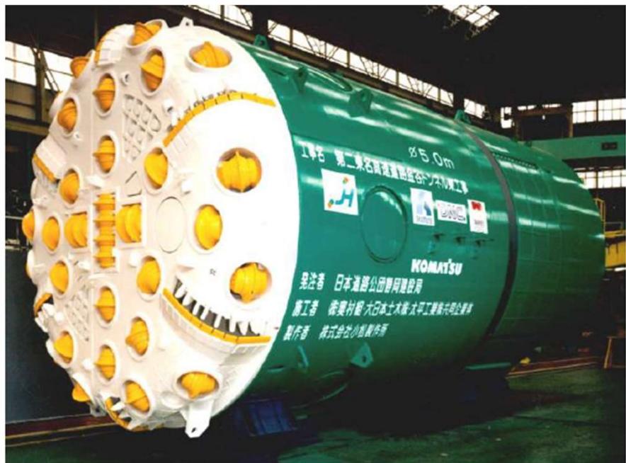
日本道路公団／第二東名高速道路 金谷トンネル (φ5000mm ダブルシールド型)
