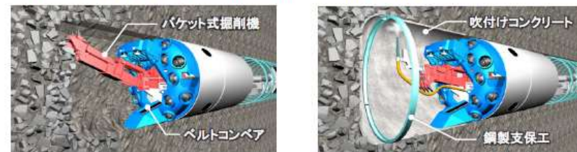
バケット掘削機で掘削
