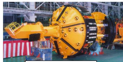
φ7.0m 斜坑TBM (リリング切下り)
