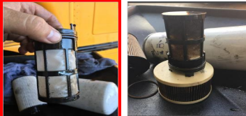
【参考②】フィルターの比較 (左：RD、右：軽油)
