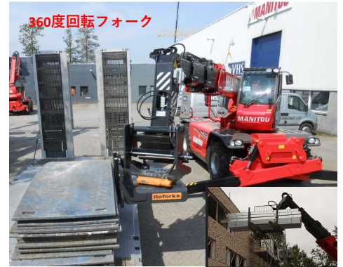
ラフタークレーン同様 本体旋回 ブームが起伏・伸縮する
