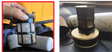
【参考②】 フィルターの比較 (左: RD、右: 軽油) *6,400km走行車両の比較
