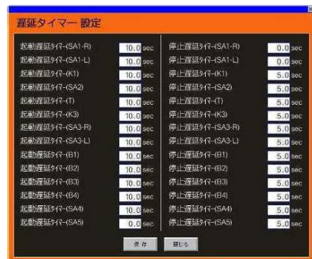
ベルコン遅延タイマー
