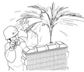
えんじんとめたあとすぐらじえーたのふたをあけない
