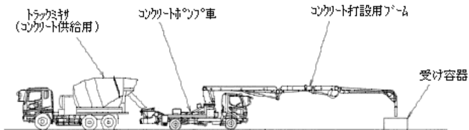
図1—ブーム付きコンクリートポンプ車の圧送試験
